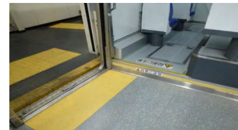
〔ドア開口部床識別色と車内床段差部の注意喚起表示(黄色)〕
