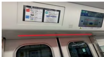
〔扉開閉表示灯〕
