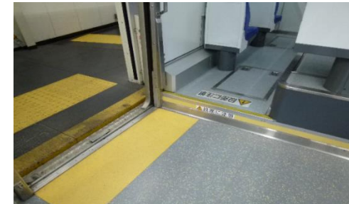
〔ドア開口部床識別色と車内床段差部の注意喚起表示(黄色)〕
