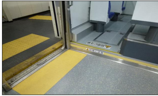
〔ドア開口部床識別色と車内床段差部の注意喚起表示(黄色)〕
