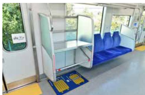
車内に設置した荷物置き場
