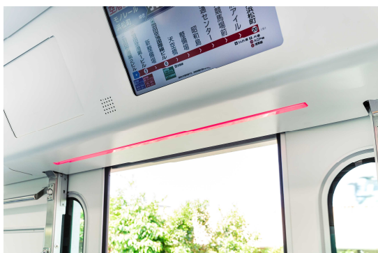
〔扉開閉表示灯〕
