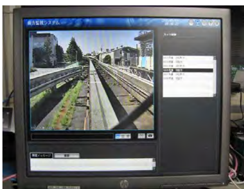
〔地上側モニタ装置〕
