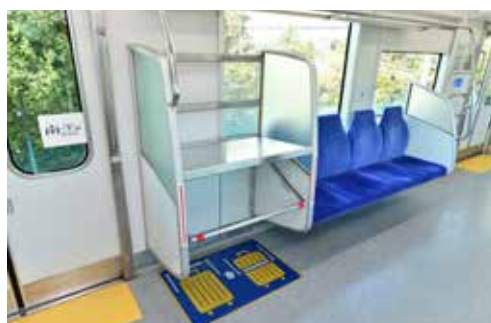
車内に設置した荷物置き場
