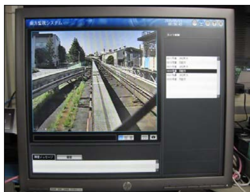
〔地上側モニタ装置〕
