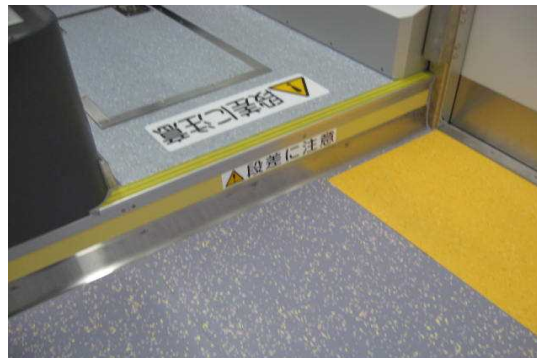
〔ドア開口部床識別色と車内床段差部の注意喚起表示 (黄色)〕
